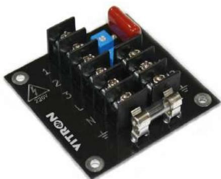
Управление одним или группой АС-вентиляторов 220В с помощью настенного термостата.
