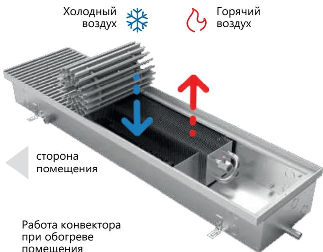
Работа конвектора при обогреве помещения
